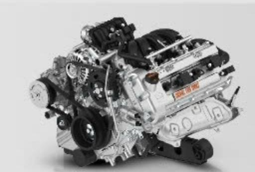
Động cơ xăng 1.6L công nghệ Nhật Bản trang bị hệ thống phun xăng điện tử kết hợp van biến thiên DVVT giúp tăng công suất mạnh mẽ và tăng khả năng tiết kiệm nhiên liệu.
